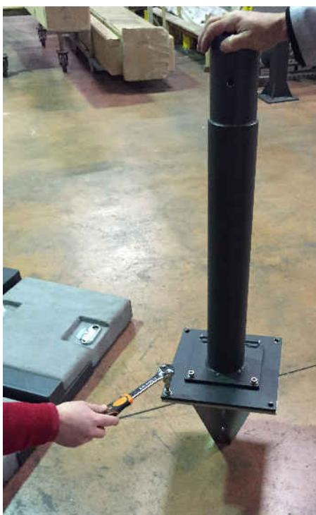
I. Avvitare le 4 viti esterne a brugola da 10 mm che troverete incluse con l'ombrellone in modo da fissare il tubo rotondo alla base.
