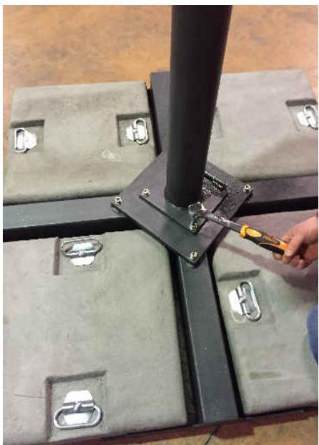
I. Svitare le 2 viti interne a brugola da 10 mm in modo da poter inclinare il tubo rotondo dell'ombrellone.
